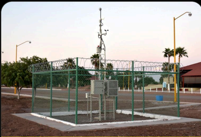
La estación meteorológica en el Valle del Yaqui, México: mástil de sensores y armario de campo.
