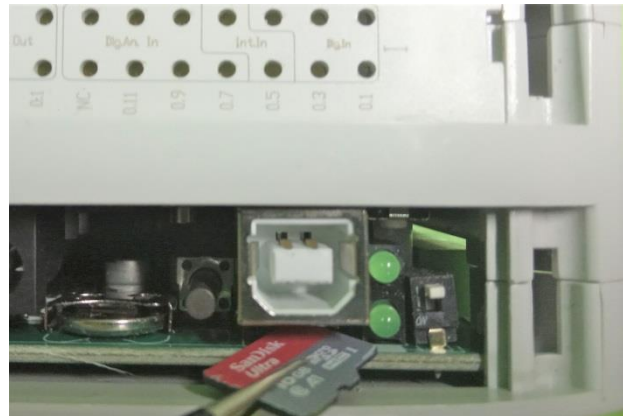
Fig. 4.5.2. Introducción de tarjeta microSIM en su slot (uso de pinzas recomendado)
