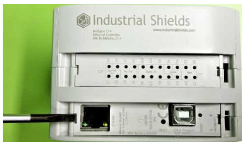
Fig. 4.5.1. Instrucciones para apertura de tapa superior del SLC19R (acceso a slot de tarjeta microSD)
