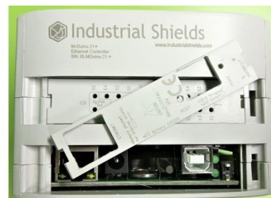
Fig. 4.5.1. Instrucciones para apertura de tapa superior del SLC19R (acceso a slot de tarjeta microSD)
