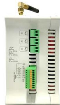
Un analizador de red eléctrica monitorea el voltaje y la intensidad de tres líneas; estos datos son procesados por el PLC y enviados periódicamente a través de GPRS a los servidores de la oficina central; esto permite determinar el estado de la red eléctrica, detectar posibles fallos y realizar un mantenimiento predictivo.
